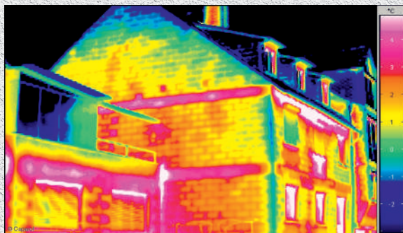
Imaginea 1. Prin tehnica termografiei, pierderile de căldură sunt evidențiate de suprafețele roșiatice.
