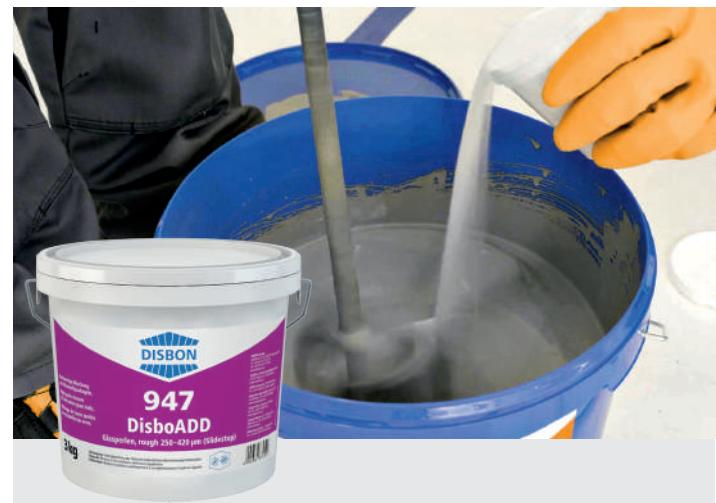
Prin utilizarea perelor din sticlă **DisboADD 947 Glasperlen** (SlideStop) se poate regla rugozitatea pardoselii. Astfel puteți obține suprafete rugoase și antiderapante. Perlele de sticlă se amestecă în ultimul strat de acoperire, iar ulterior amestecul rezultat se aplică cu rola. Ele se integrează armonic în aspectul suprafetei finale datorită faptului că sunt transparente.
